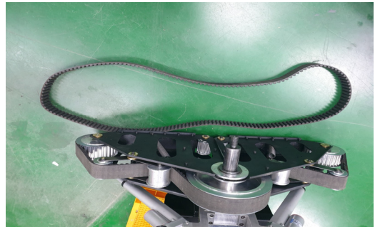
(d) Assembled gear unit and track wheel
